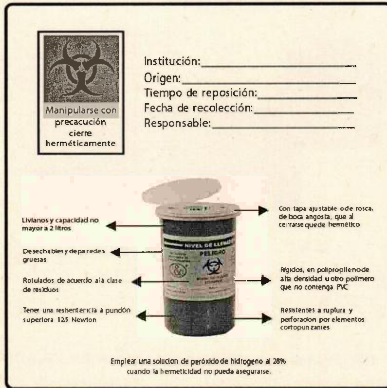
Figura 12. Especificaciones técnicas de recipientes para residuos cortopunzantes.
