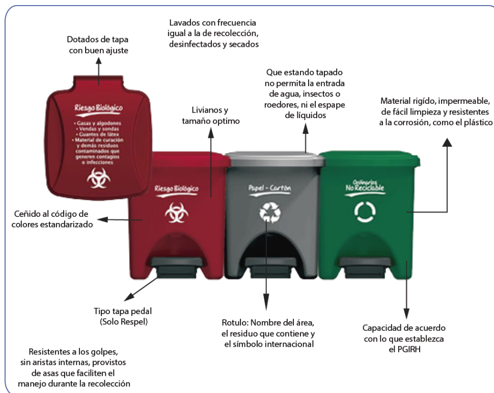
FIGURA 6. ESPECIFICACIONES TÉCNICAS DE LOS RECIPIENTES REUTILIZABLES.
