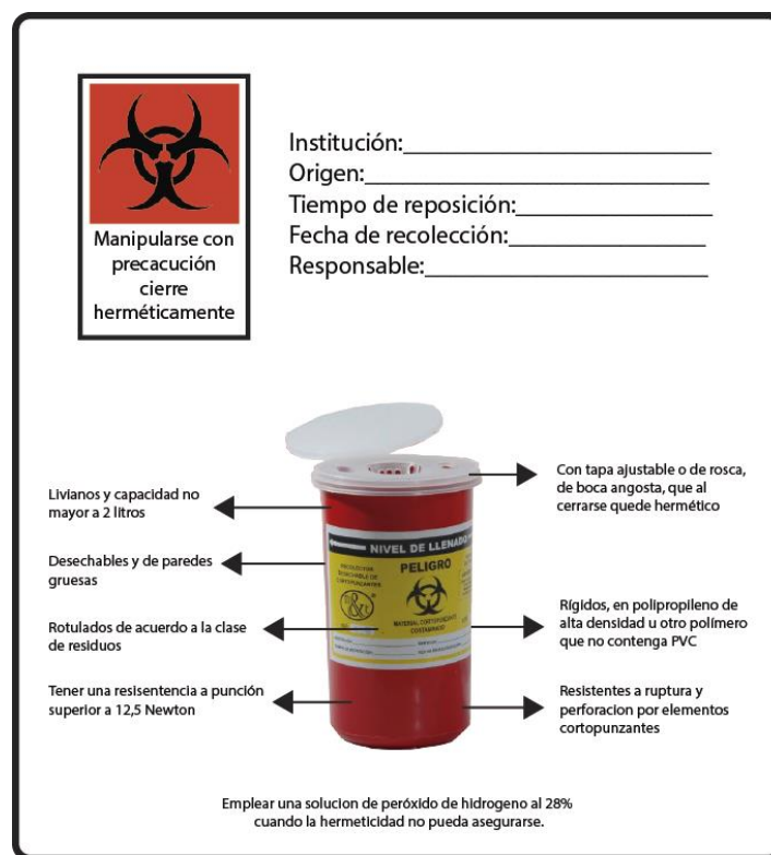
FIGURA 8. ESPECIFICACIONES TÉCNICAS DE RECIPIENTES PARA RESIDUOS CORTOPUNZANTES
