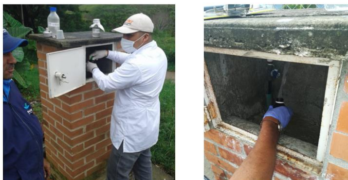
Figura 17. Toma de muestra de agua de consumo humano en el punto concertado con el prestador del servicio, en presencia de un delegado del prestador.
